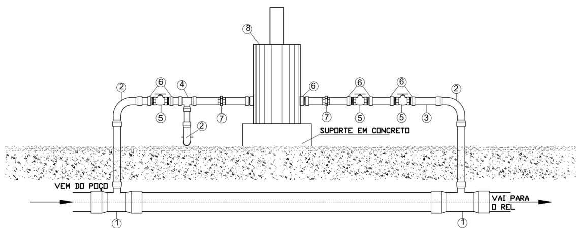
CORTE AA' DA INSTALAÇÃO DO CLORADOR
