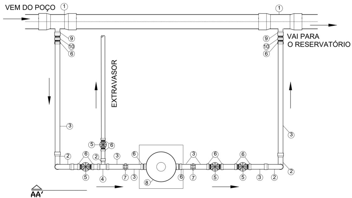
PLANTA DA INSTALAÇÃO DO CLORADOR
